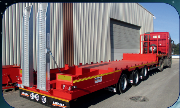
SEMI-REMORQUE POUR LE TRANSPORTS DE CAISSE DE BOIS ET CHARIOT DE MANUTENTION
