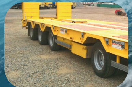
VERSION 3+1 (3 ESSIEUX EN LIGNE ET 1 ESSIEU ISOLÉ)
