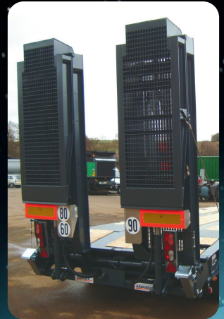
REVÊTEMENT DES RAMPES EN CAILLEBOTIS
