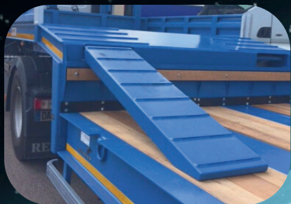
RAMPES D'ACCÈS AU COL DE CYGNE
