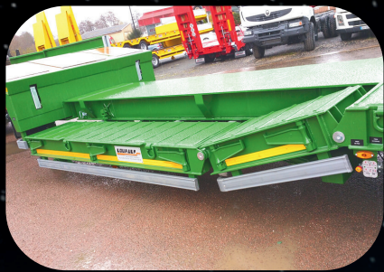
FOSSES LATÉRALES À ÉLÉVATION HYDRAULIQUE
