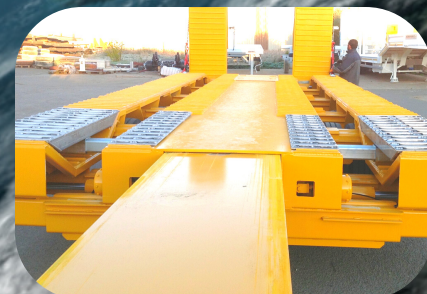
ÉCARTEMENT HYDRAULIQUE DES RIVES + TÉLESCOPIQUES
