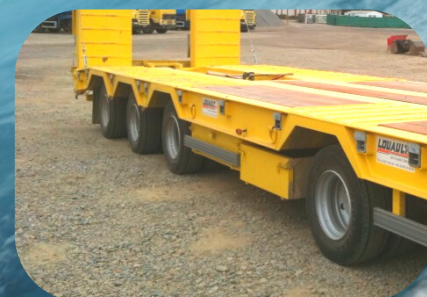
VERSION 3+1 (3 ESSIEUX EN LIGNE ET 1 ESSIEU ISOLÉ)
