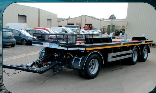
Elles sont spécialement conçues pour le transport de bennes dans le cadre du recyclage des matériaux et disposent des options suivantes :
