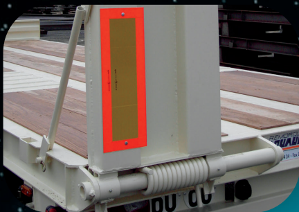
RELEVAGE DES RAMPES PAR RESSORT COMPENSATEUR
