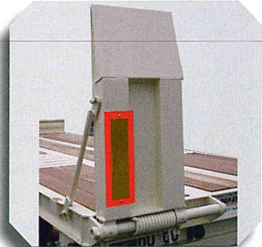
Relevage des rampes par ressort compensateur
