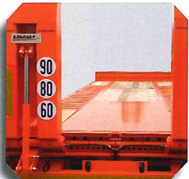
Rampes relevables et réglables en largeur hydrauliquement
