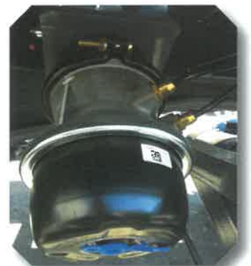
Verrouillage pneumatique des caissons
