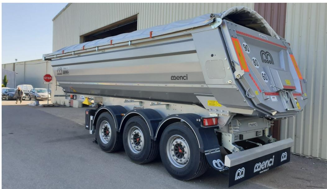
**Châssis acier avec benne acier Hardox 500 Volume 24m<sup>3</sup>**
