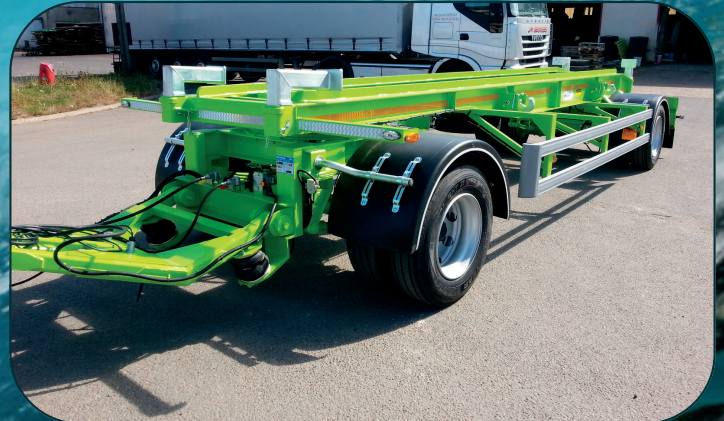
REMORQUE SANS PISTE AVEC RAIL DE GUIDAGE INTÉRIEUR
