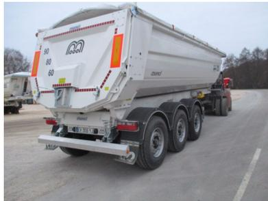
**Châssis alu avec Benne alu 740 Volume 27m<sup>3</sup>**
